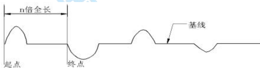
图（22） 近端故障冲闪测试波形
