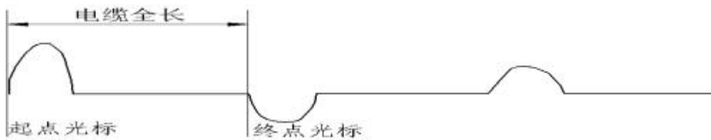
图（19） 闪络测试故障点不放电波形
